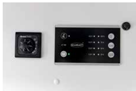
Boordcontrolepaneel display met niveaumeter en weergave accucapaciteit
