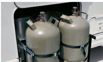
» Gasflessen wisselen is een koud kunstje d.m.v. een uittrekbare slede
