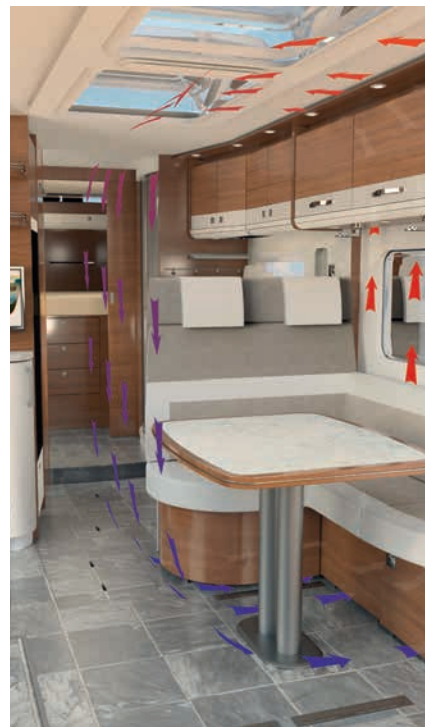
» Het AirPlus systeem voorkomt condensvorming
